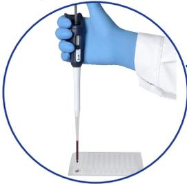
Volumeneinstellung sichtbar auf der Vorderseite des Handgriffs während des Pipettierens
